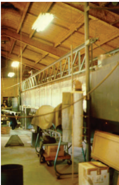
Mynd 18.16. Vindgöng í Big Spring í Texas sem notuð voru til að þróa áfram vindrofsjöfnuna. Þarna er verið að undirbúa tilraun með íslenska mold en niðurstöðurnar sýndu einstæða rofgirni íslenskra jarðvegsefna og gjósku.
